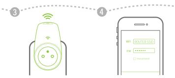
Branchez le NEO à une prise de courant, puis appuyez sur le bouton ON/OFF et maintenez enfoncé pendant 5 secondes. Relâchez le bouton lorsque le voyant Wi-Fi se met à clignoter rapidement. L'interrupteur NEO est maintenant prêt pour la synchronisation.
